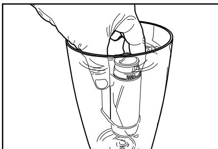
**3** 從咖啡機上取下水箱倒空。取出水箱中的白色濾水器，存放在乾燥無灰塵處。
