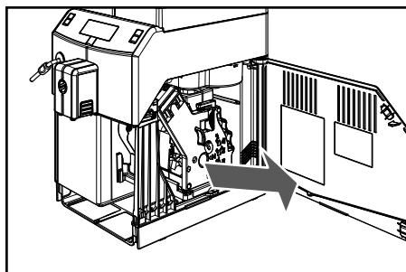
**4** 取出沖煮系統：拉動把手，按下「PUSH」（推）按鈕。沖煮系統務必僅使用溫水清洗。不要使用清潔劑。
