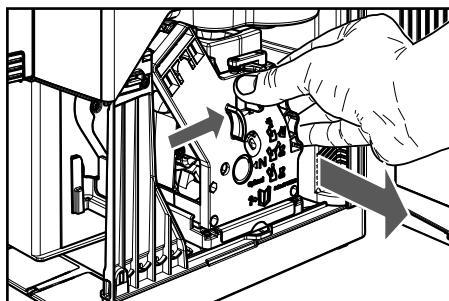
**5** 以溫水清洗沖煮系統，並仔細洗淨上濾水器。將沖煮系統放回底座之前，要確定已將沖煮壺中的水份瀝乾。
