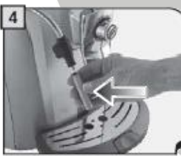
4 取下蒸氣管清洗乾淨 再裝回原處
