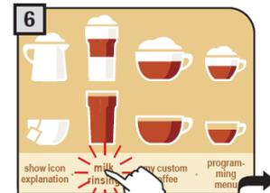
飲料製作完成之後螢幕上牛奶殘渣“milk rinsing”的字樣將閃爍不停此時如按一下此訊息機器將做一次內部牛奶管路清洗
